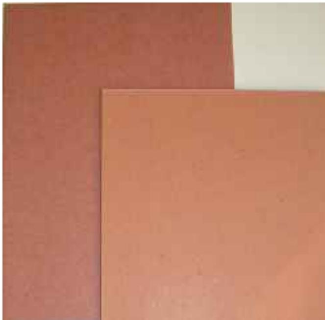
(1) - Cartone non patinato, prodotto con pasta legno, estremamente compatto, resistente allo sfaldamento, con caratteristiche di buon assorbimento delle colle ed elevata resistenza all'umidità.
